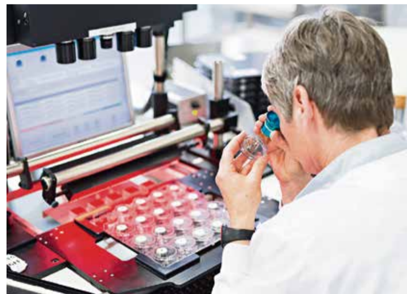
Les mouvements horlogers, anonymes, passent quinze jours dans les bureaux du COSC et subissent une batterie de tests pour vérifier leur précision. Pour obtenir la précieuse certification, la marge de tolérance est de -4/+6 secondes par jour. (MATHIEU SPOHN POUR LE TEMPS)
