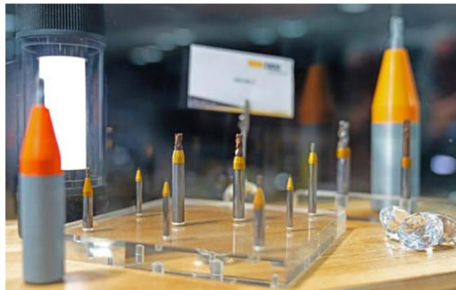
Grâce à son faible coefficient de friction, le revêtement Drycut améliore l'évacuation des copeaux et augmente la durée de vie des outils dans les matériaux non ferreux. Les qualités géométriques de la gamme 1137 lui permettent d'être efficace également dans
